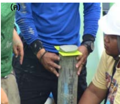
รูปที่ 3.2 วิธีการเก็บตัวอย่าง (ก) อุปกรณ์การเก็บตัวอย่างดินตะกอนแบบ Box corer (ข) ตะกอนดินตัวอย่างแท่งที่ 1 (ค) ตัวอย่างชั้นตะกอนดินในแท่งที่ 2 และ (ง) วิธีการตัดชั้นตะกอนดิน
