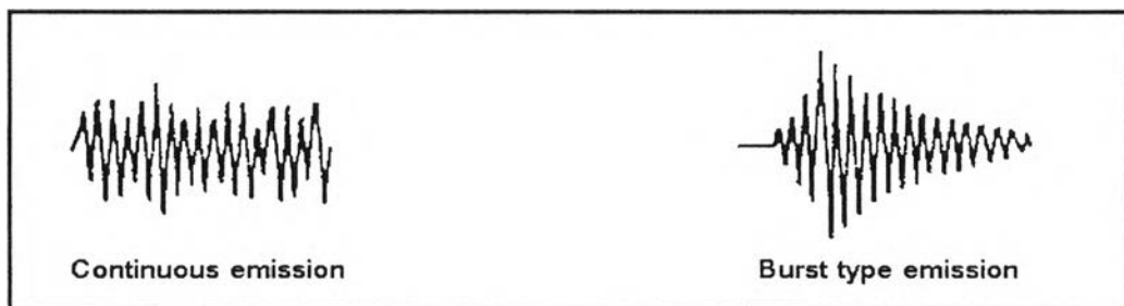
รูปที่ 2.5 สัญญาณอะคูสติกแบบต่อเนื่องและแบบปะทุ
