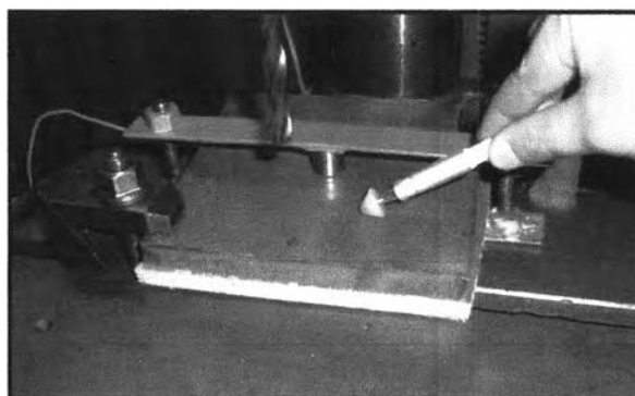
รูปที่ 3.6 การสร้างสัญญาณโดยการหักใส่ดินสอด
