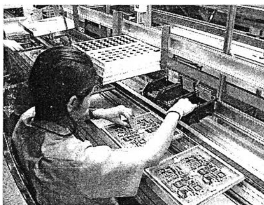
รูปที่ 5.2 สายพานช่วงที่ 1 ของสายการประกอบแผ่นวงจร Function Key Board
