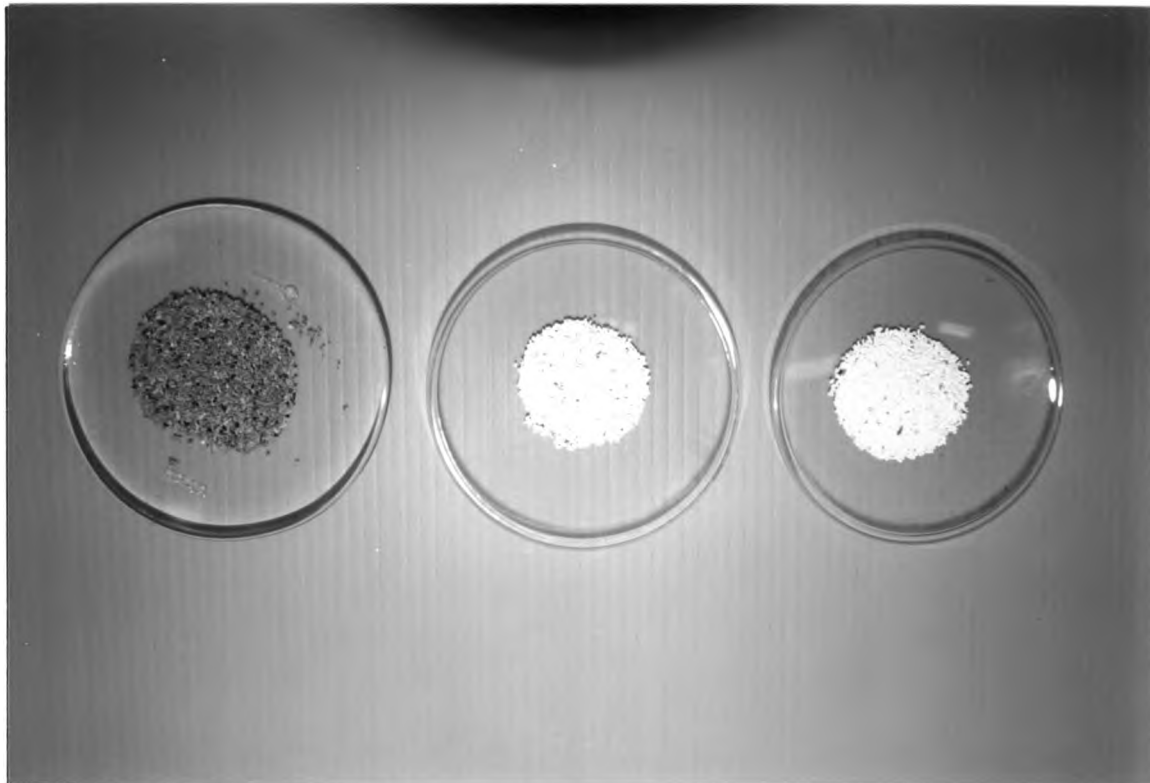
รูปที่ 4.2 กระจุกป่นที่เตรียมโดยเผาที่อุณหภูมิ 600, 800 และ 1000 องศาเซลเซียส ขนาด 0.42-0.84 มิลลิเมตร (จากซ้ายไปขวา)
