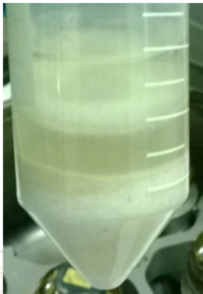
รูป 4.15 ตัวอย่างข้าวกล้องที่ผ่านการสกัดด้วยเทคนิค QuEChERS
