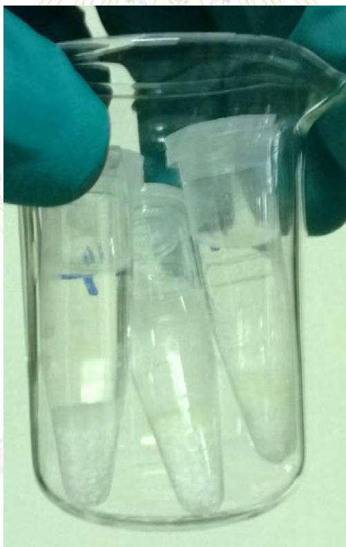
รูป 4.16 ตัวอย่างข้าวกล้องที่ผ่านการสกัดด้วยเทคนิค QuEChERS หลอดทดลองซ้ายมือเติมตัวดูดซับ C-18, กลางเติมตัวดูดซับ PSA และ ขวามือเติมตัวดูดซับ PSA และ C-18
