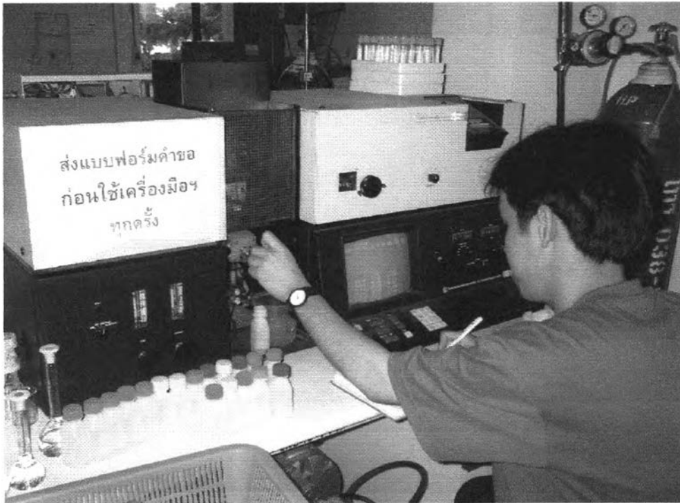
รูปที่ 3.1 เครื่องอะตอมมิกแอบซอร์ปชันสเปกโตรโฟโตมิเตอร์ (Atomic Adsorption Spectrophotometer)
