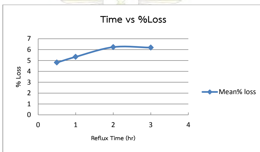
รูปที่ 8 ความสัมพันธ์ของเวลาที่ใช้ในการย่อยแร่และ % Loss ที่ 80 °C [HCl] 9.0 M
