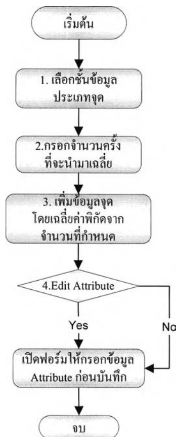
รูปที่ 3.40 แผนผังโปรแกรมนำข้อมูลจุดโดยใช้เครื่องรับสัญญาณจีพีเอส
