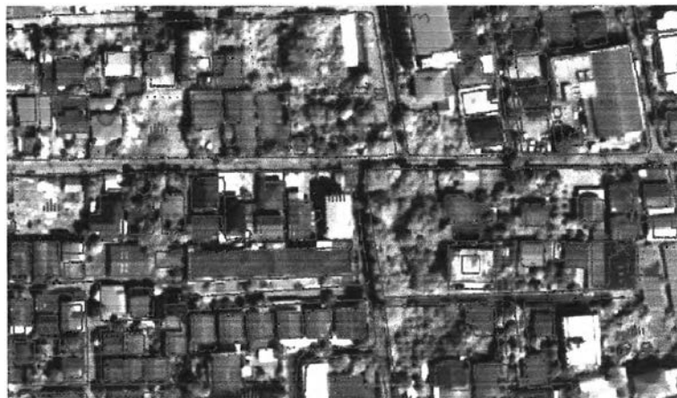
รูปที่ 3.11 แสดงการซ้อนทับแผนที่กรุงเทพมหานครมาตราส่วน 1:4000 กับภาพถ่ายดาวเทียมที่ผ่านการปรับแก้โดยใช้จุดควบคุมภาพจาก GPS
