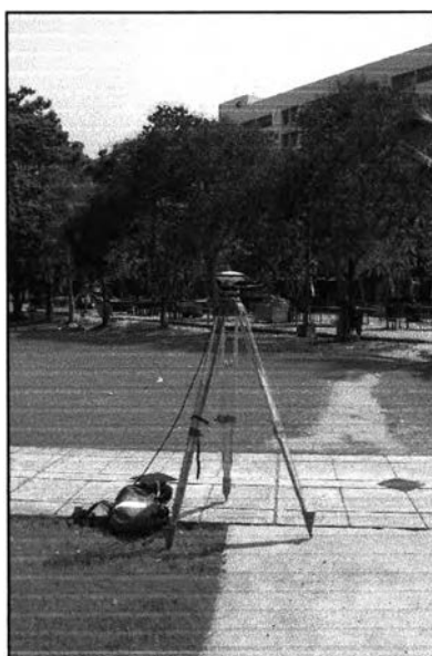
รูปที่ 3.4 แสดงการรับสัญญาณดาวเทียมแบบสถิตอย่างรวดเร็ว
