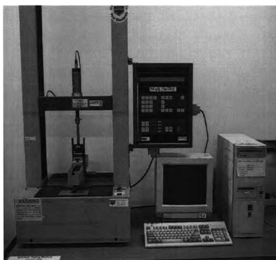
รูปที่ 3.7 เครื่อง Universal Testing Machine ของ LLOYD รุ่น 500
