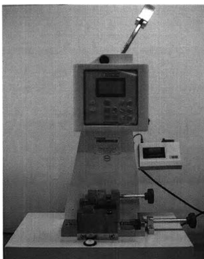
รูปที่ 3.9 เครื่องทดสอบความต้านแรงกระแทกของ Gotech รุ่น GT-7045MD
