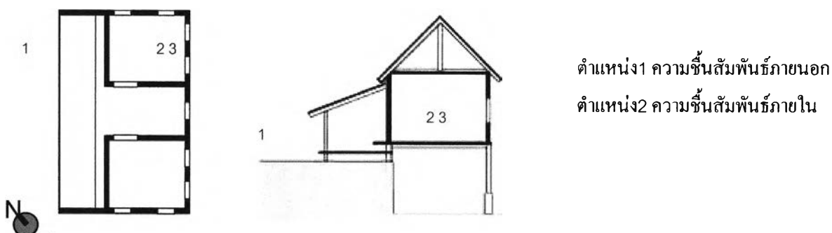
รูป3.24 ตำแหน่งติดตั้งอุปกรณ์วัดความชื้นสัมพัทธ์ภายนอก และความชื้นสัมพัทธ์ภายใน เรือนวิภาวดีรังสิต
