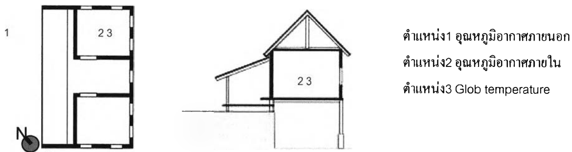
รูป3.23 ตำแหน่งติดตั้งอุปกรณ์วัดอุณหภูมิอากาศภายนอก ภายใน และ Glob temperature เรือนวิภาวดีรังสิต
