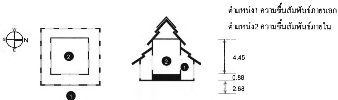
รูป3.18 ตำแหน่งติดตั้งอุปกรณ์วัดความชื้นสัมพัทธ์ภายนอก และความชื้นสัมพัทธ์ภายใน หอไตร วัดทุ่งศรีเมือง
