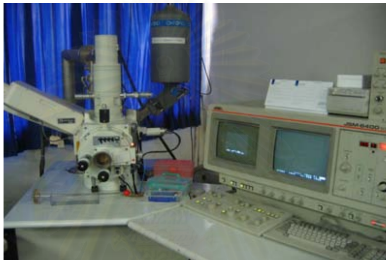
รูปที่ 3.12 กล้องจุลทรรศน์อิเล็กตรอนแบบส่องกราด (JSM-6400)
