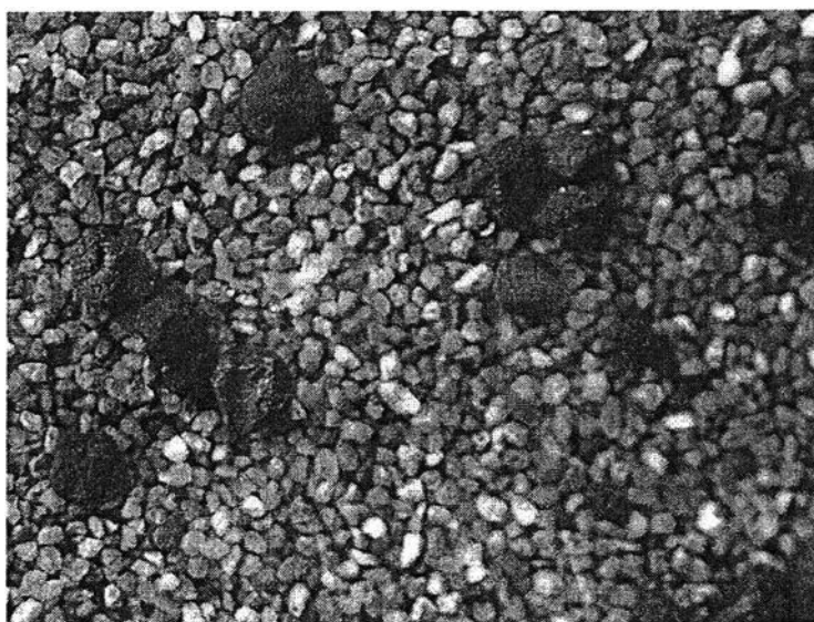
รูปที่ 4.11 อนุภาคของแข็งภายหลังจากการทดลองในเครื่องฟลูอิดไคซ์เบดแบบหมุนเวียน ที่อุณหภูมิ 750 องศาเซลเซียส ความดันบรรยากาศ ใช้แก๊สไนโตรเจนเป็นแก๊สพา
