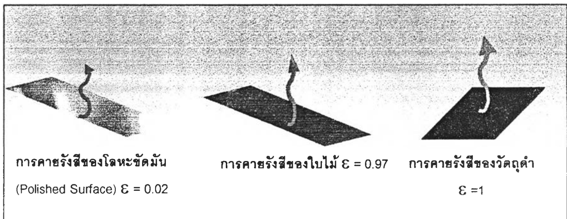
ภาพที่ 2 - 14 เปรียบเทียบค่าการคายรังสีความร้อนของพื้นผิววัสดุ ได้แก่ ไม้ ไม้ โลหะขัดมัน และวัสดุอโลหะ
