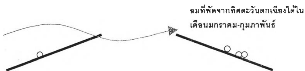
ภาพที่ 2 - 11 สมมติฐานการเกิดปริมาณน้ำค้างจากแผ่นทดลองที่วางทิศทางแตกต่างกัน
