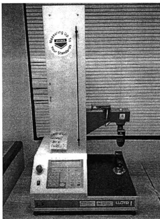
รูปที่ 3.8 เครื่องทดสอบแรงกด (universal testing machine) ของ LLOYD รุ่น LF plus
