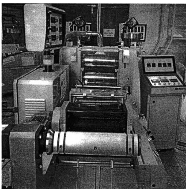
รูปที่ 3.3 เครื่องรีดหล่อฟิล์ม (chill roll casting) ของ Labtech engineering company รุ่น LCR-300HDCO-EX
