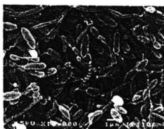
ค. ภาวะบรรทุกสารอินทรีย์ 40 กก.ซีโอดี/ลบ.ม.-วัน (ความเร็วไหลขึ้น 5 ม./ชม.)
