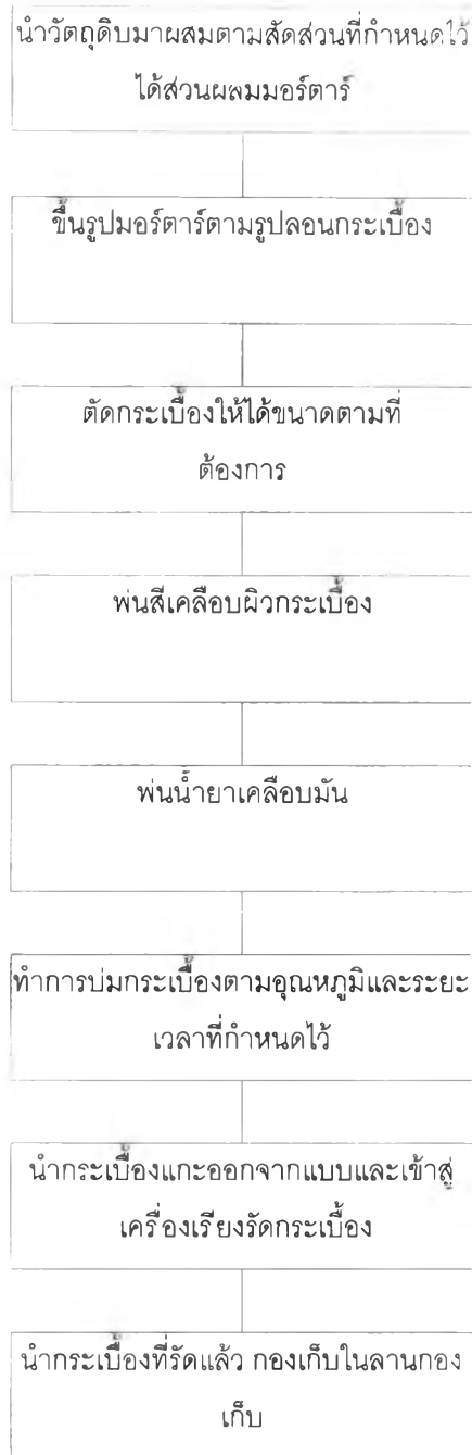
รูปที่ 3.1 ขั้นตอนการผลิตกระเบื้องคอนกรีตมุงหลังคา
