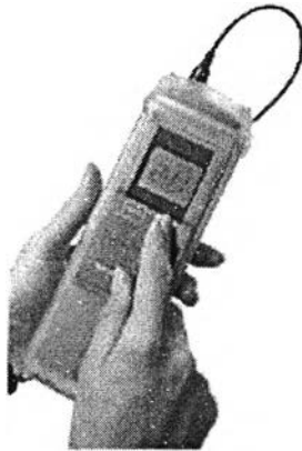
รูปที่ 5.5 แสดงลักษณะของอุปกรณ์วัดอุณหภูมิแบบเคลื่อนที่
