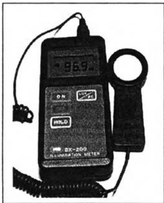
รูปที่ 1 แสดงลักซ์มิเตอร์ รุ่น DX-200
