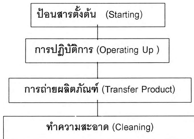
รูปที่ 2.1 วงจรการดำเนินการของกระบวนการแบบแบทช์
