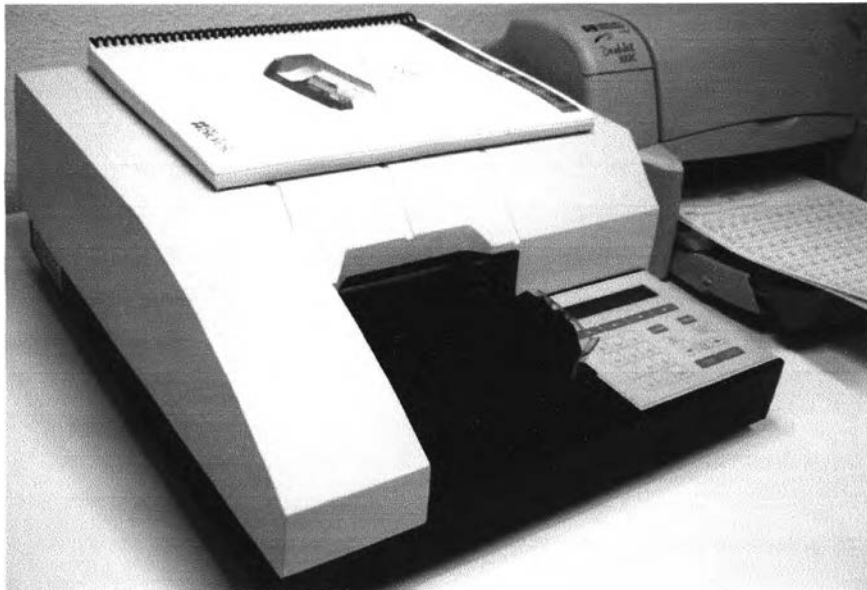
รูปที่ 3.5 แสดงเครื่องไมโครเพลทรีดเดอร์ รุ่น ELX 800 ที่ใช้ในการวิจัย
