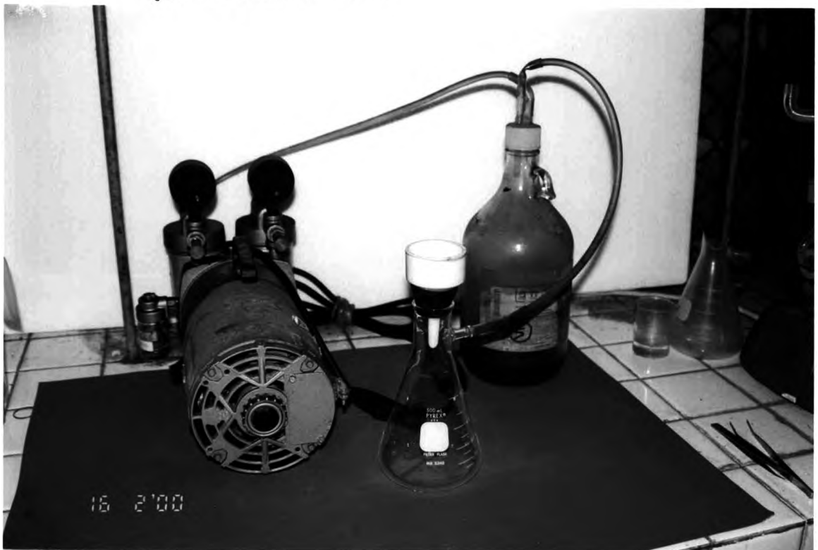
รูปที่ 5 เครื่องกรองใช้กรองสารละลายที่ผ่านการสกัดสารตามประกาศกระทรวงอุตสาหกรรม ฉบับที่ 6
