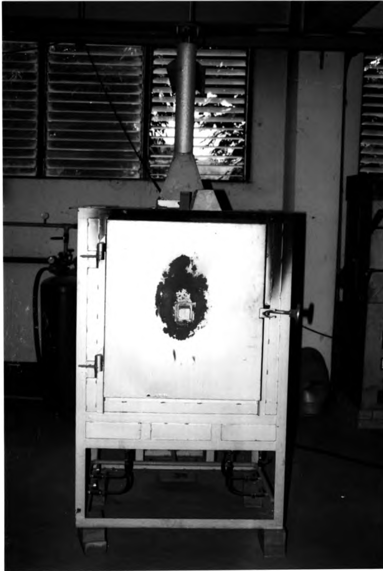
รูปที่ 3 เตาเผาใช้เผาากตะกอนน้ำมันเตาที่ 800 และ 1200°C ที่ภาควิชาวัสดุศาสตร์ คณะวิทยาศาสตร์ จุฬาลงกรณ์มหาวิทยาลัย
