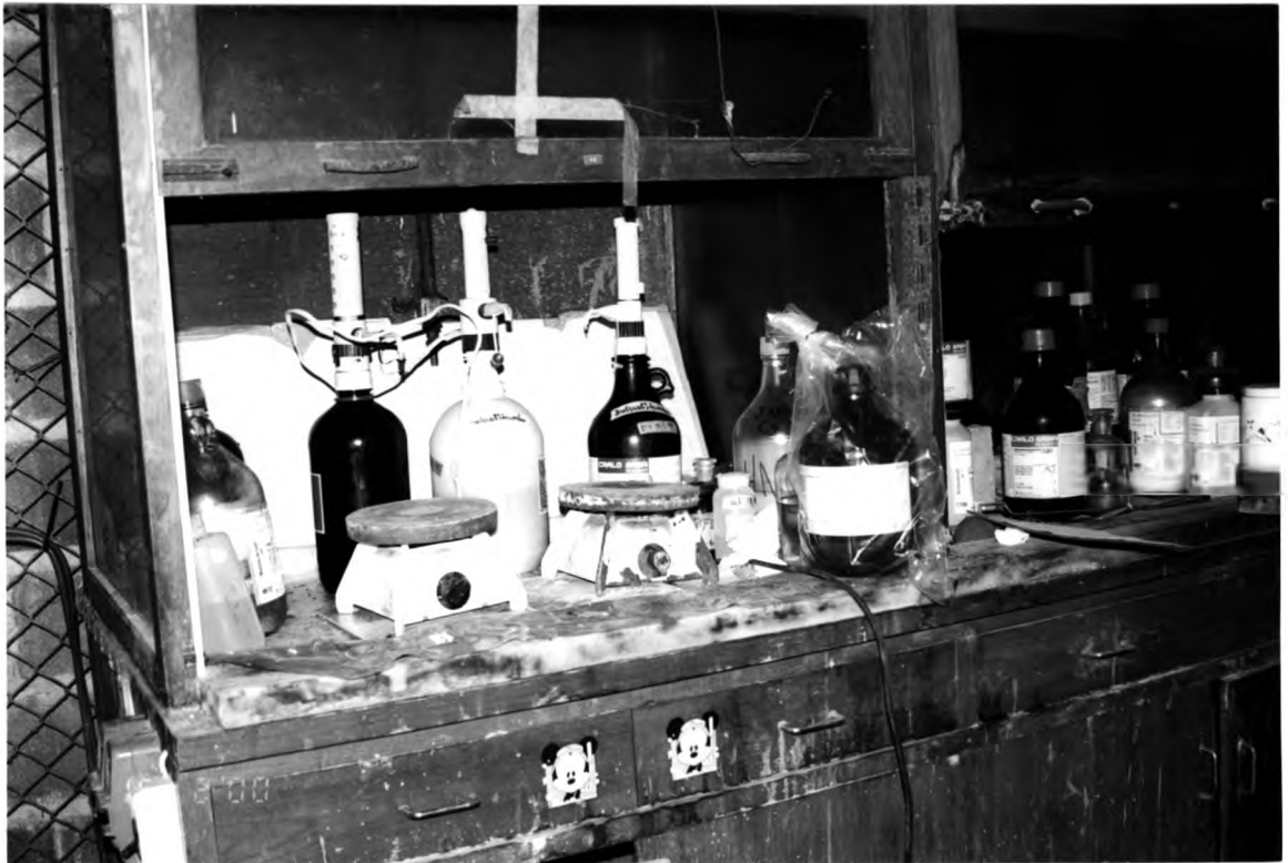
รูปที่ 6 เตาความร้อนและตู้ดูดควันที่ใช้ในการทำ digest
