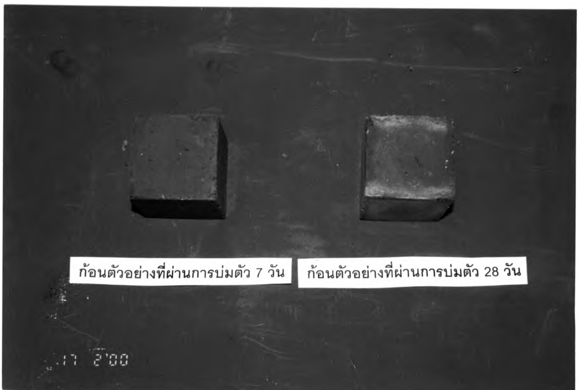
รูปที่ 3 ก้อนตัวอย่างของซีเมนต์กากตะกอนน้ำมันเตา ที่ 400° C ระยะเวลาบ่ม 7 และ 28 วัน
