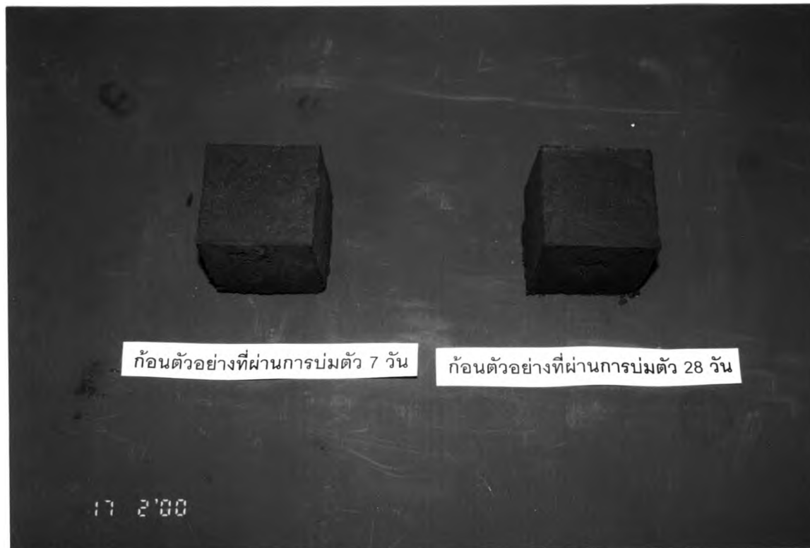
รูปที่ 5 ก้อนตัวอย่างของซีเมนต์จากตะกอนน้ำมันเตา ที่ 1200^{\circ}\text{C} ระยะเวลาบ่ม 7 และ 28 วัน
