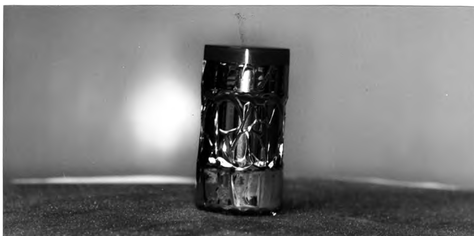
รูปที่ 3.1 กระบอกเก็บตัวอย่างน้ำจากสระว่ายน้ำ หุ้มกระดาษทึบแสงมีฝาปิด
