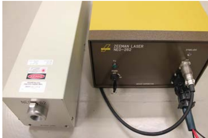
รูปที่ 3.1 แหล่งกำเนิดแสงเลเซอร์ฮีเลียม-นีออนและชุดควบคุมกระแสไฟฟ้า
