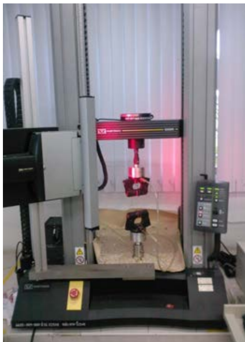
รูปที่ 3.18 เครื่อง Instron testing machine (Instron 5843)
