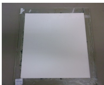
รูปที่ 3.16 แม่แบบที่ทำจากแผ่นกระจกขนาด 20 \times 20 \times 0.15 เซนติเมตร
