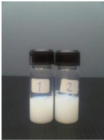
รูปที่ 6.1 ตัวอย่างของพอลิสไตรีนและซิลิกาห่อหุ้มด้วยพอลิสไตรีนนาโนเลเท็กซ์
