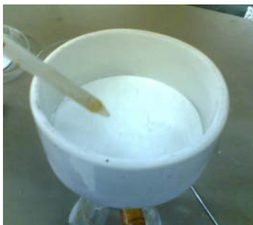
รูปที่ 3.8 การล้างและกรองอนุภาคระดับนาโนที่เตรียมได้ด้วยเครื่องกรองสุญญากาศ
