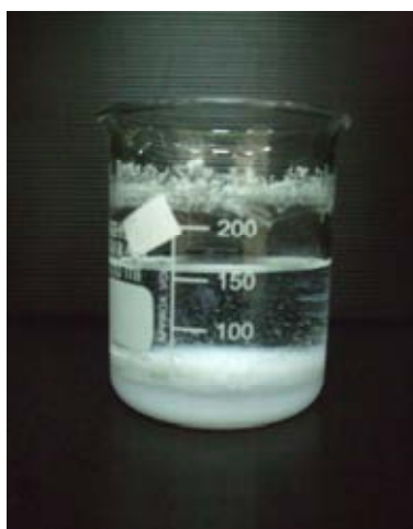
รูปที่ 3.7 การตกตะกอนพอลิเมอร์ด้วยเมทานอลปริมาณมากเกินไป
