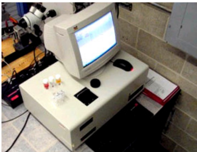
รูปที่ 3.11 เครื่องวิเคราะห์ขนาดอนุภาคด้วยเทคนิคกระเจิงแสงแบบพลวัต (Nano-series ZX)
