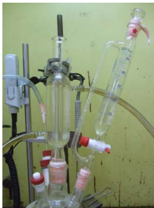
รูปที่ 3.5 การติดตั้งกรวยสำหรับหยดมอนอเมอร์
