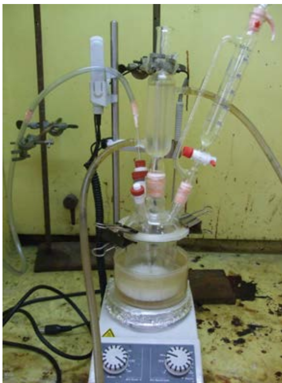
รูปที่ 3.4 การติดตั้งเครื่องปฏิกรณ์ เครื่องควบคุม และท่อ นำแก๊ส
