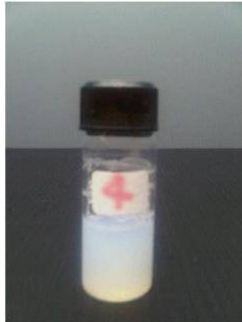
รูปที่ 7.1 ตัวอย่างของซิลิกาห่อหุ้มด้วยพอลิเมทิลเมทาคริเลตนาโนเลเท็กซ์
