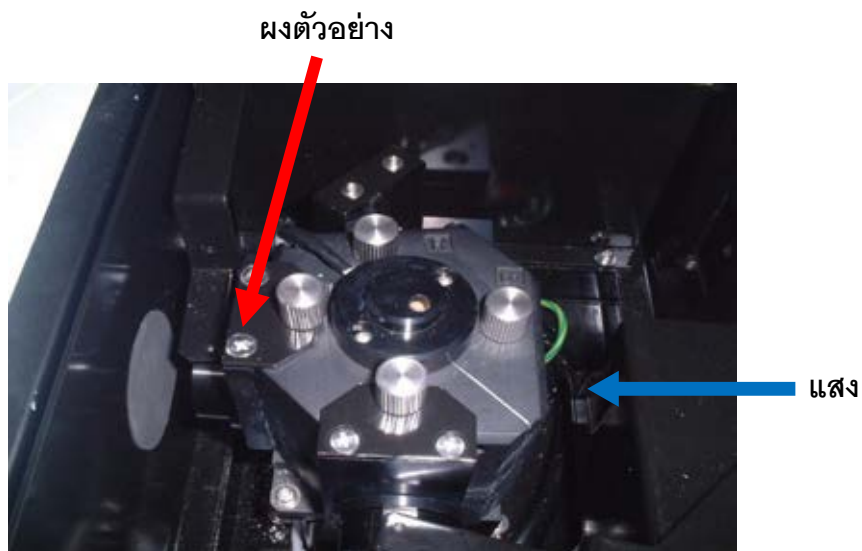
ภาพที่ 3.11 ผงตัวอย่างกระจายบนผงแบเรียมซัลเฟต
