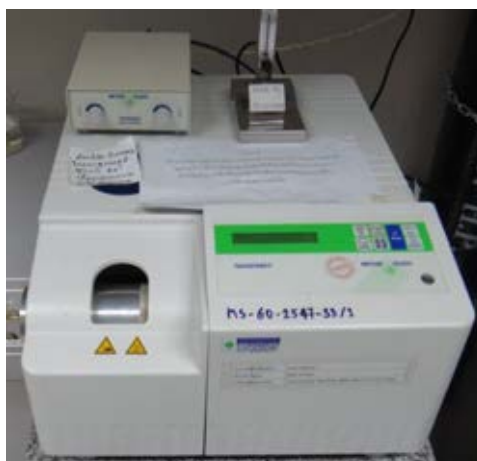
รูปที่ 3.7 เครื่อง TGA ของ Mettler Toledo รุ่น TGA/SDTA851e
