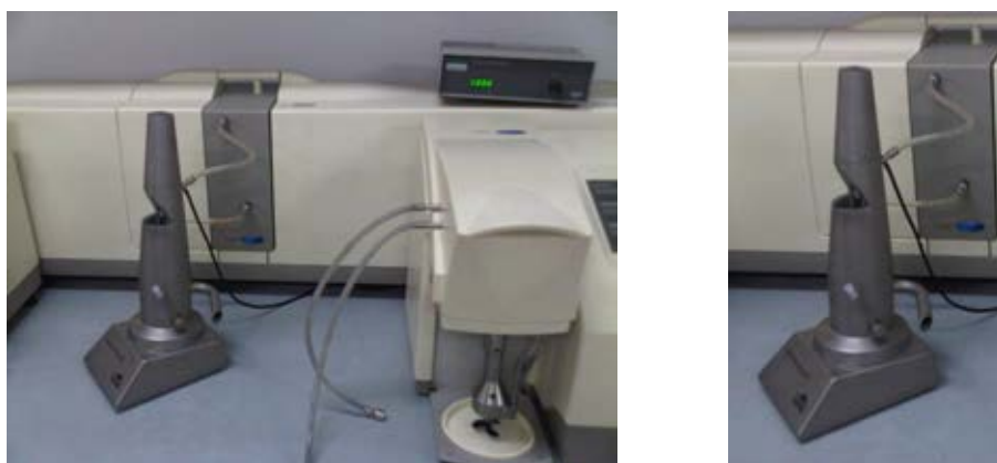
รูปที่ 3.6 (a) เครื่อง LPSDA ของ Malvern รุ่น Mastersizer 2000 และ (b) หน่วยกระจาย Hydro 2000SM
