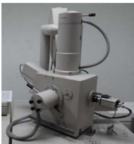
รูปที่ 3.5 เครื่อง SEM ของ Philips รุ่น XL30CP
