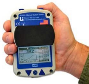
รูปที่ 22 แสดงเครื่องวัดกำลังสถิติของกล้ามเนื้อ
