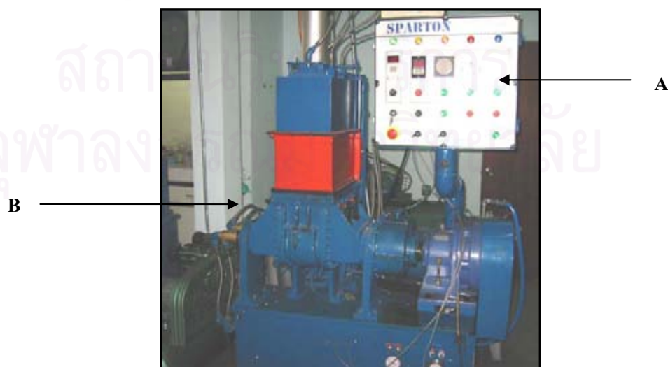
รูปที่ 3.2 เครื่องบดผสมภายใน (internal mixer)
