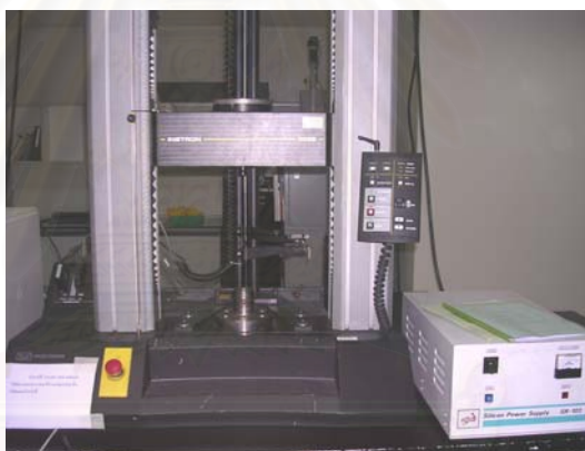
รูปที่ 3.6 เครื่องทดสอบความต้านทานแรงดึง (Universal Testing Machine)
