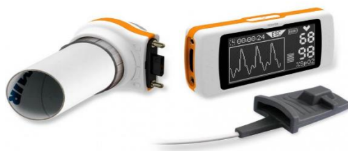
รูปที่ 9 เครื่องวัดปริมาตรการหายใจ (Spirometer)
