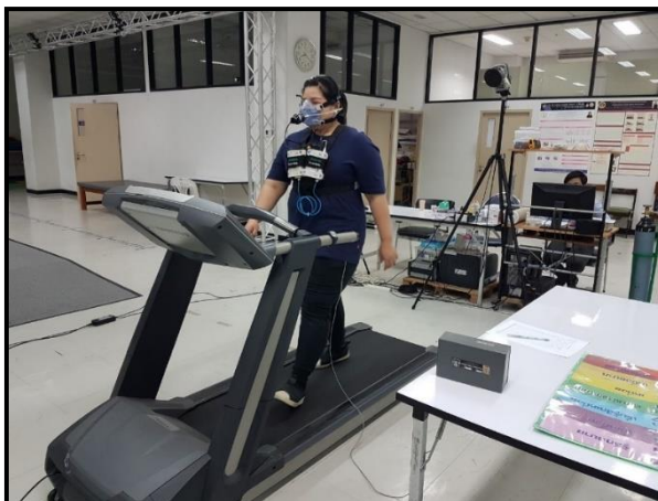
ภาพที่ 3.4 การวัด substrate oxidation และ energy expenditure ด้วยเครื่องวิเคราะห์ก๊าซจาก ลมหายใจแบบพกพาขณะทดสอบการออกกำลังกาย
