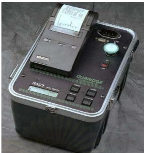
รูปที่ 2.7 เครื่องตรวจวัดระดับความเข้มข้นของก๊าซเรดอนที่มีชื่อทางการค้าว่า RAD7
