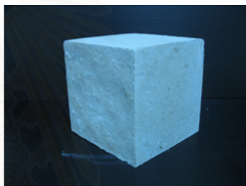
รูปที่ 3.13 แบบขึ้นรูปคอนกรีตรูปทรงลูกบาศก์ขนาด 15 ซม. × 15 ซม. × 15 ซม และตัวอย่างคอนกรีต
