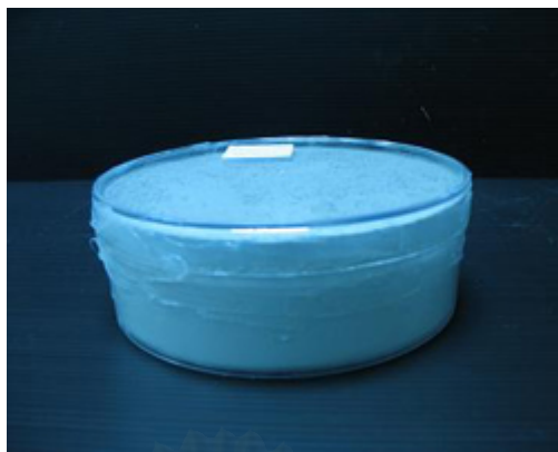
รูปที่ 3.10 ตัวอย่างปูนซีเมนต์พอร์ตแลนด์ประเภท 1 ที่ทำการปิดผนึกสำหรับการวัดรังสีแกมมา
