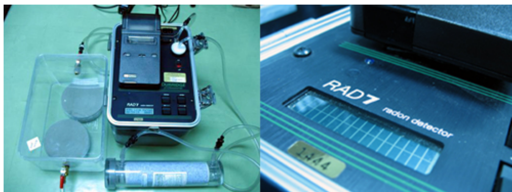
รูปที่ 3.15 ระบบการตรวจวัดระดับความเข้มข้นเรดอนด้วยเครื่องตรวจวัดระดับความเข้มข้นของก๊าซเรดอนที่มีชื่อทางการค้าว่า RAD7
