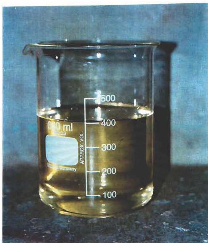
รูปที่ 3 แสดงลักษณะน้ำเสียตัวอย่างที่ได้หลังจากการบำบัดด้วยวิธีออกซิเดชั่นและการตกตะกอน
