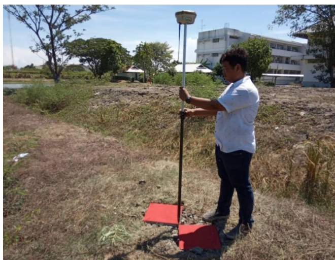
รูปที่ 4.16 การรังวัดจุดบังคับภาพถ่ายภาคพื้นดินด้วยวิธี RTK
