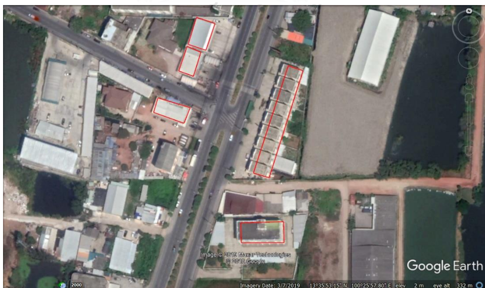
รูปที่ 4.11 ตัวอย่างรอยพิมพ์ฐานอาคารที่ได้จากการรังวัดบนภาพถ่ายเฉียง
