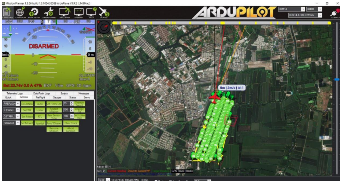
รูปที่ 4.4 การวางแผนการบินถ่ายภาพสำหรับระบบกล้องชุดถ่ายภาพเฉียง
