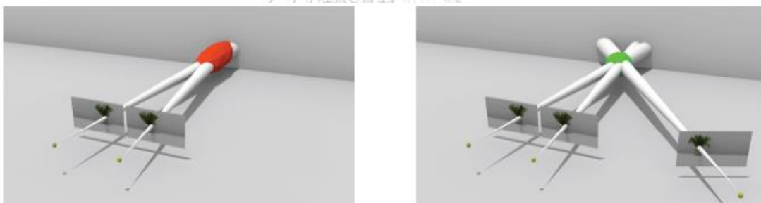
รูปที่ 2.7 การรังวัดค่าพิกัด 3D จาก Stereo Pair และการรังวัดค่าพิกัด 3D จาก Multi View Stereo ที่มา : (Strecha, 2014)
