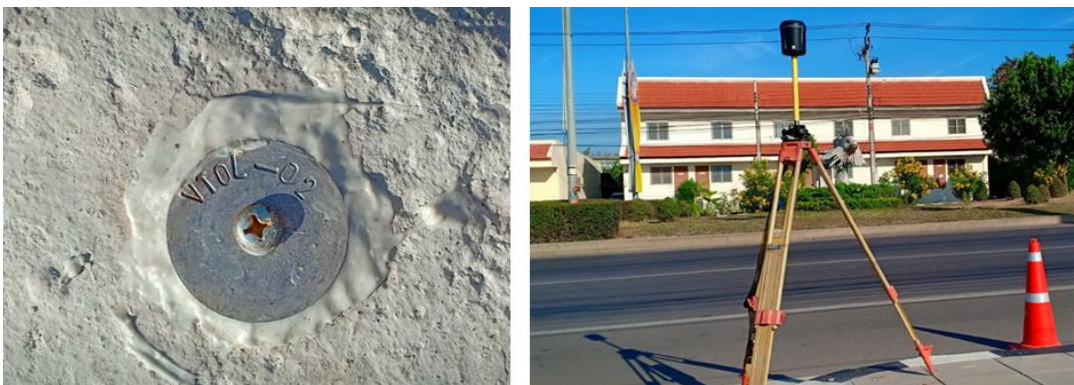
รูปที่ 4.13 หมุดอ้างอิงค่าพิกัด VTOL-02 บริเวณเชิงสะพานข้างคลองบางหญ้า
