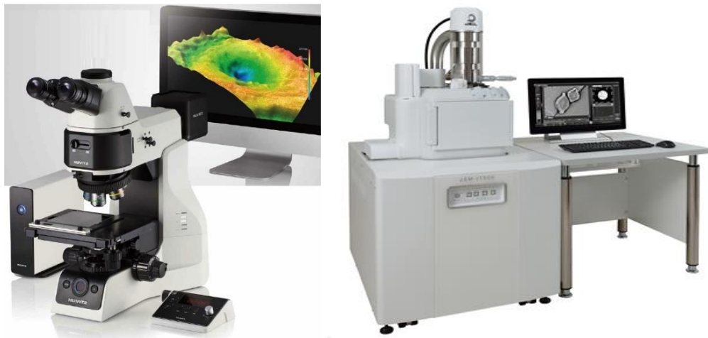
รูปที่ 47 การตรวจสอบโครงสร้างจุลภาคด้วยกล้องจุลทรรศน์แบบใช้แสง (ซ้าย) [36] และกล้องจุลทรรศน์อิเล็กตรอนแบบส่องกราด (ขวา) [37] ตามลำดับ
