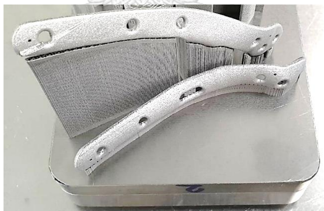
รูปที่ 56 ชิ้นงานโลหะตามกระดูกที่ผ่านการขึ้นรูปด้วยเทคนิค Selective Laser Melting
