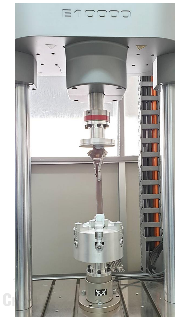
รูปที่ 63 การทดสอบทางชีวกลศาสตร์ของโลหะตามกระดุกต้นแขนส่วนปลาย เมื่อทดสอบความ แข็งแรงในทิศทางตามแนวแกน
