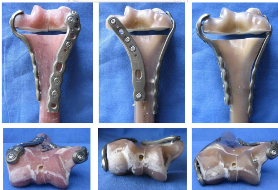
รูปที่ 7 โลหะตามกระดูกต้นแขนส่วนปลายแบบคู่ ประเภท medial-posterior lateral 90° (ซ้าย) ประเภท posterior medial-lateral 90° (กลาง) และประเภท medial-lateral 180° (ขวา) [2]
