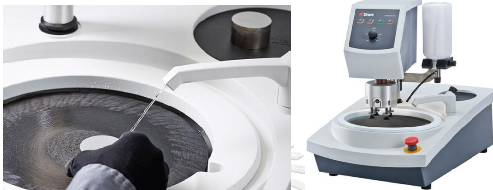
รูปที่ 46 การขัดหยาบชิ้นงานด้วยเครื่องขัดอัตโนมัติ [34]
