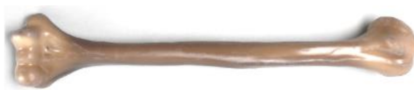
รูปที่ 58 กระดูกสังเคราะห์ที่ผลิตจากวัสดุผสมโพลีเมอร์ ของบริษัท SAWBONE
