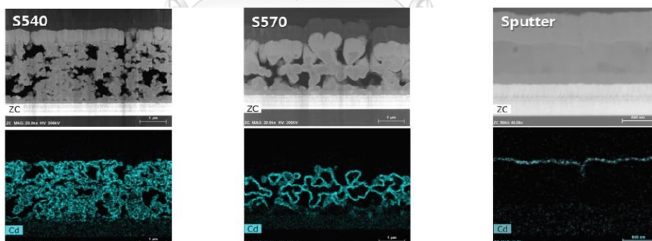
รูปที่ 11 ภาพตัดขวางของชั้นฟิล์มคอปเปอร์ซิงค์ทินซัลไฟด์ที่ถูกเตรียมโดยใช้อุณหภูมิในการหลอม 540°C และ 570°C ภายใต้บรรยากาศของซัลเฟอร์ และวิธีสปัตเตอร์ริง[33]
