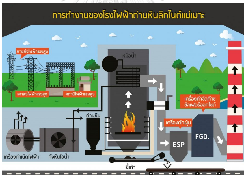
รูปที่ 1 กระบวนการทำงานของโรงไฟฟ้าถ่านหินลิกไนต์แม่เมาะ [9]
