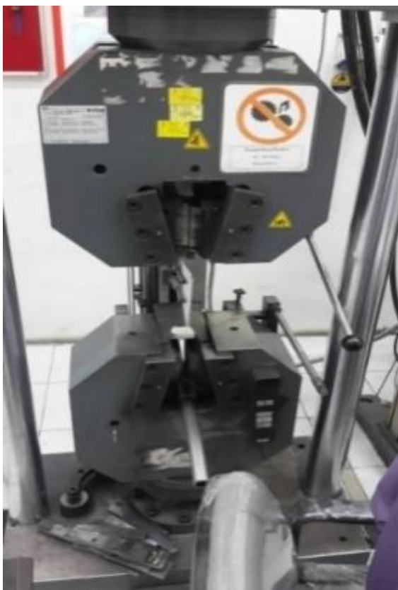
รูปที่ 4.1 เครื่องทดสอบแรงดึง Instron Model 5585H
