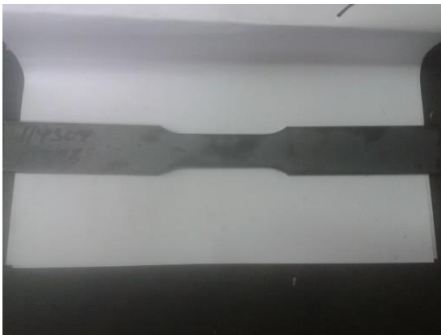
รูปที่ 4.2 ชิ้นงานตัวอย่างเพื่อทดสอบแรงดึง
