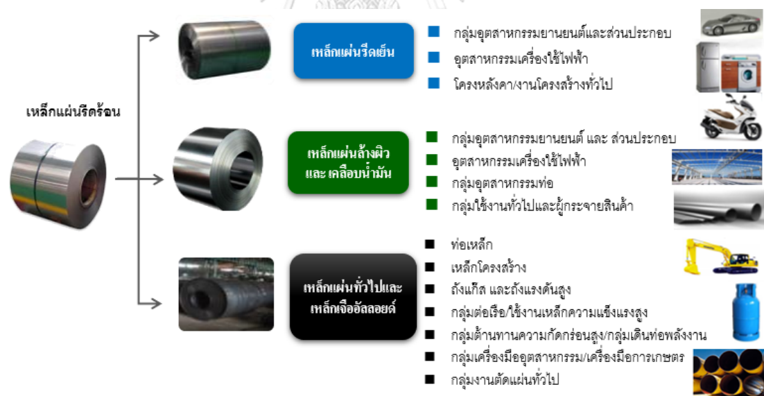
รูปที่ 1.12 โครงสร้างห่วงโซ่อุปทานของธุรกิจเหล็กแผ่นรีดร้อนชนิดม้วน และการนำไปใช้ประโยชน์
