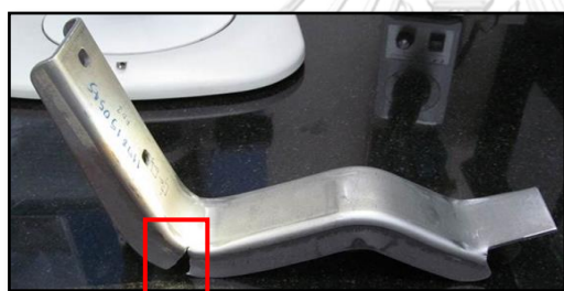
รูปที่ 1.13 ตัวอย่างปัญหาชิ้นงานจากบริเวณแถบขอบ Strip ที่มีขีดขาดเนื่องจากการยึดตัวไม่เหมาะสม
