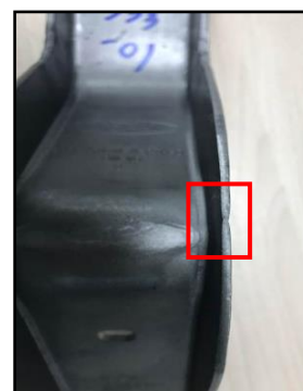
รูปที่ 1.13 ตัวอย่างปัญหาชิ้นงานจากบริเวณแถบขอบ Strip ที่มีขีดขาดเนื่องจากการยึดตัวไม่เหมาะสม
