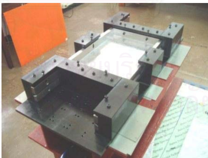
รูปที่ 5.15 การจับยึดแบบง่ายทั้งสี่ด้าน (SSSS)
