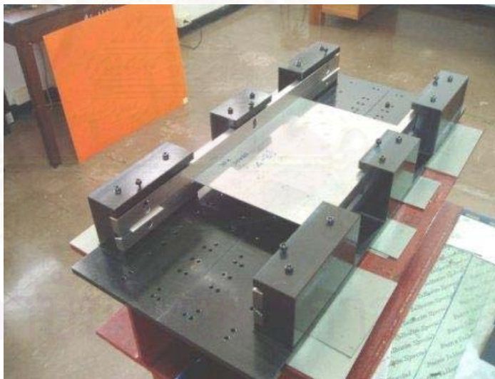
รูปที่ 5.17 การจับยึดแบบง่ายคู่ด้านตรงกันข้ามและปล่อยอิสระสองด้าน (SSFF)
