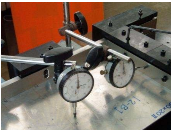
รูปที่ 5.21 การตรวจแนวระนาบของทั้งชิ้นส่วนใบมีดและแผ่นทดลอง
