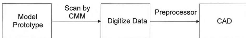
รูปที่ 3.2 แสดงขั้นตอนของการทำ Reverse Engineering
