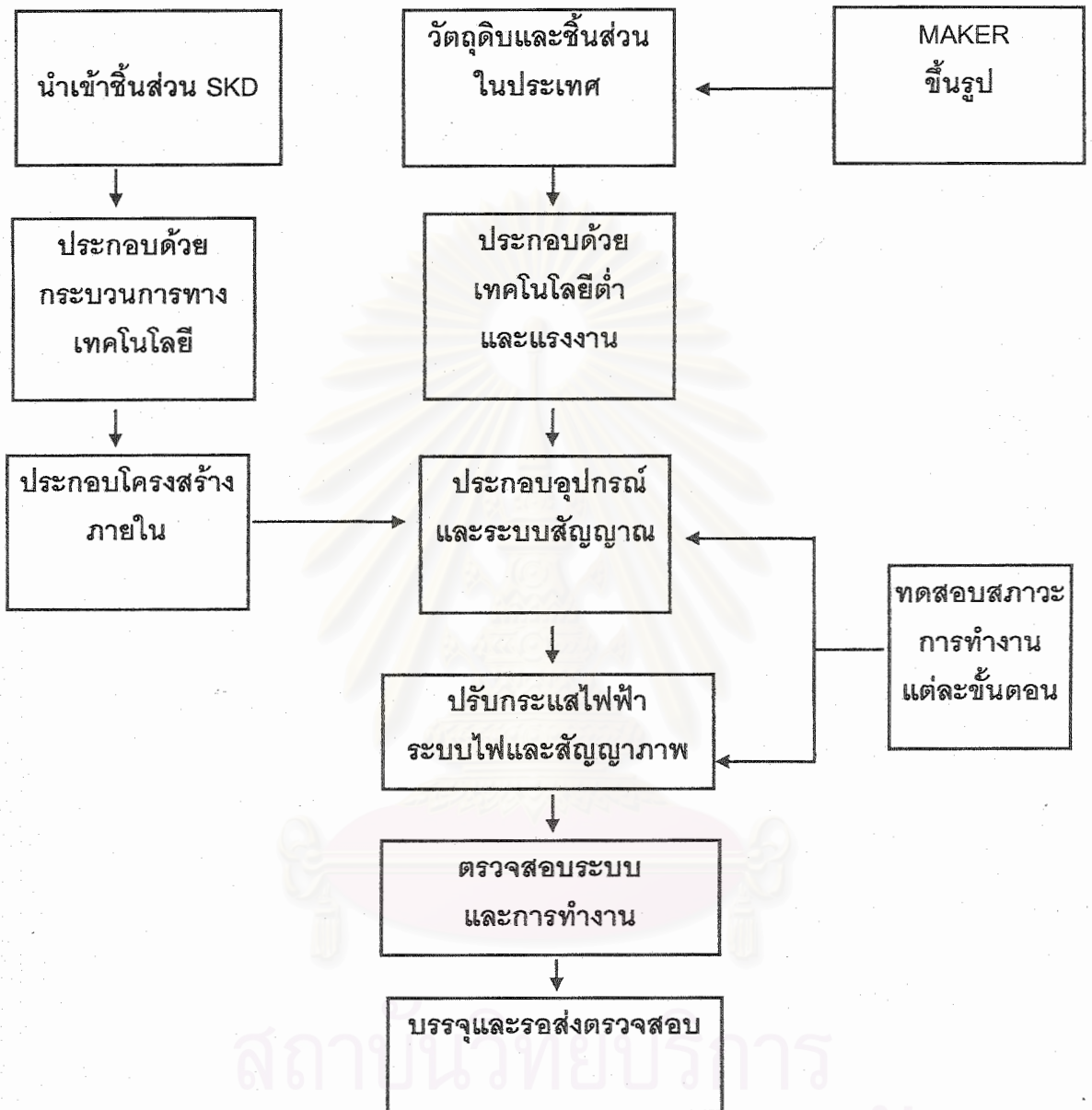
แผนภาพที่ 3.2 กระบวนการผลิตและประกอบ จอภาพ
