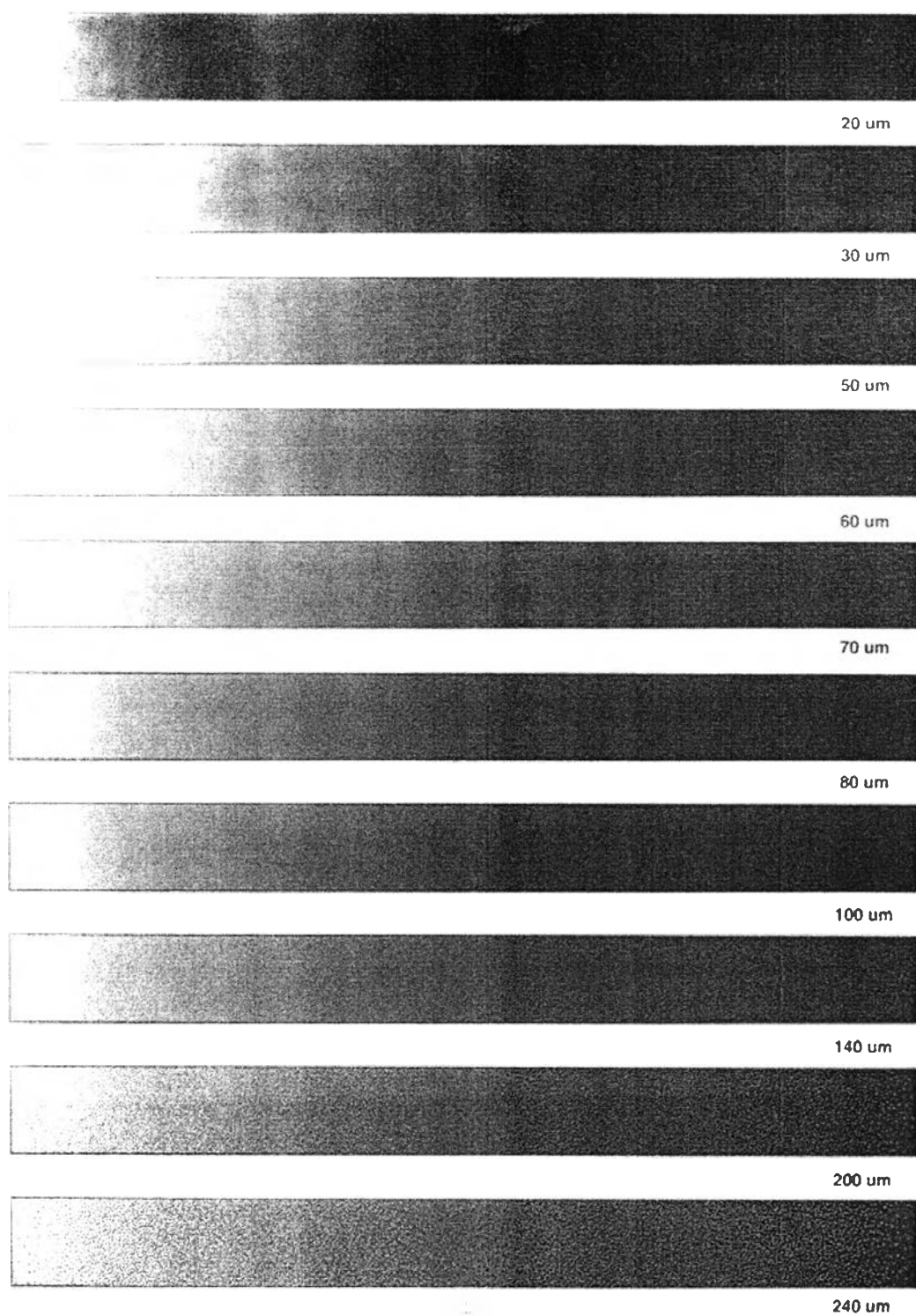
รูปที่ ง-22 ภาพการไล่น้ำหนักสีต่อเนื่องภายใต้ รองหมุนประเภทเส้นใย แม่พิมพ์ 1.14 ม.ม.
