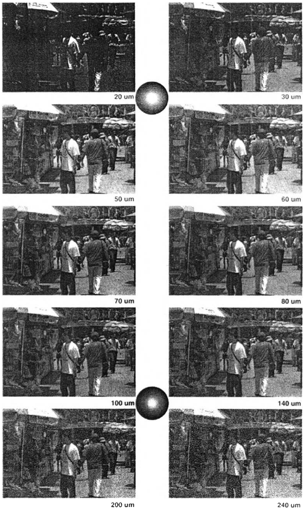
รูปที่ ง-37 ภาพฮาล์ฟโทนภายใต้ รองหมุนประเภทโฟมอ่อน แม่พิมพ์ 1.70 มม.
