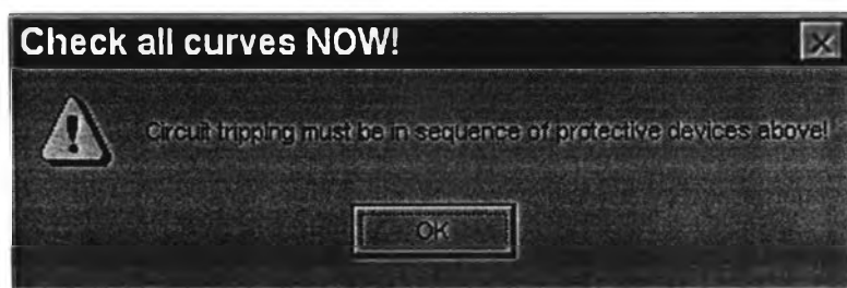
รูปที่ 7.54 Error-message box ย้ำลำดับการตัดวงจรที่ถูกต้องของสายวงจรวิเคราะห์
