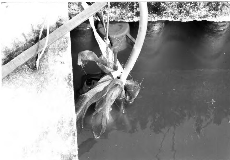
รูปที่ 3.3 แสดงการสูบน้ำจากท่อระบายน้ำโดยใช้ปั๊มสูบน้ำสู่บ่อทดลอง
