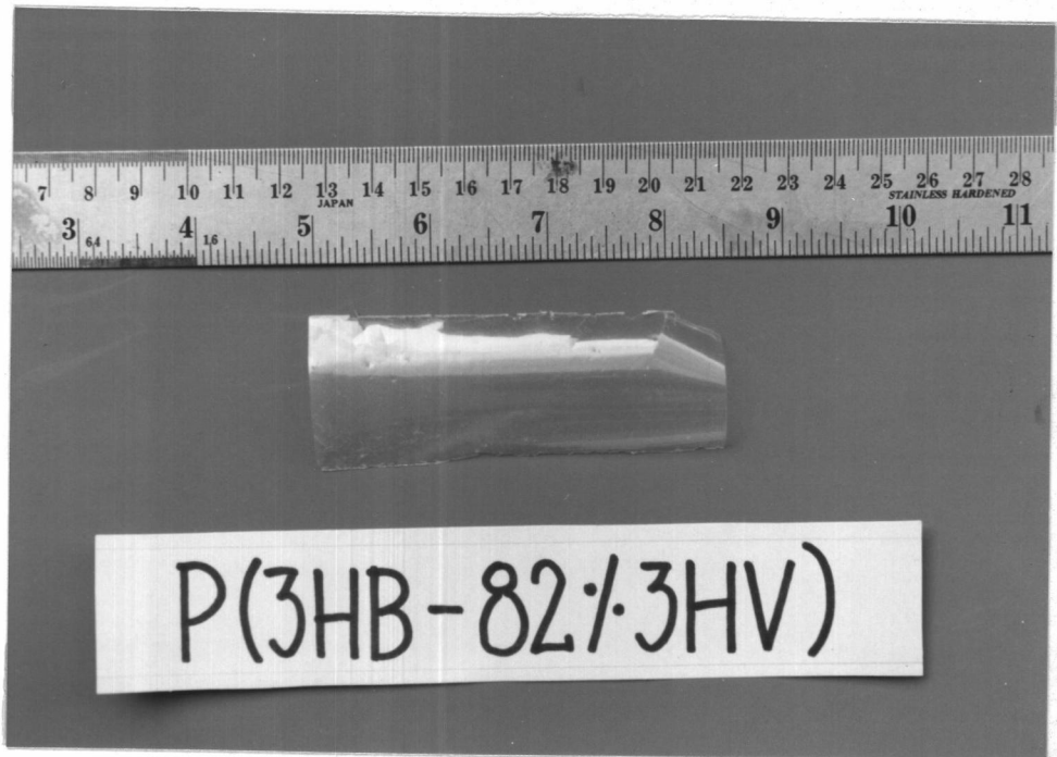
รูปที่ 31 แผ่นฟิล์มของสารผลิตภัณฑ์ P(3HB-82% 3HV) ซึ่งได้จากการเลี้ยง Alcaligenes sp. A-04 โดยผ่านการสกัดและทำให้บริสุทธิ์
