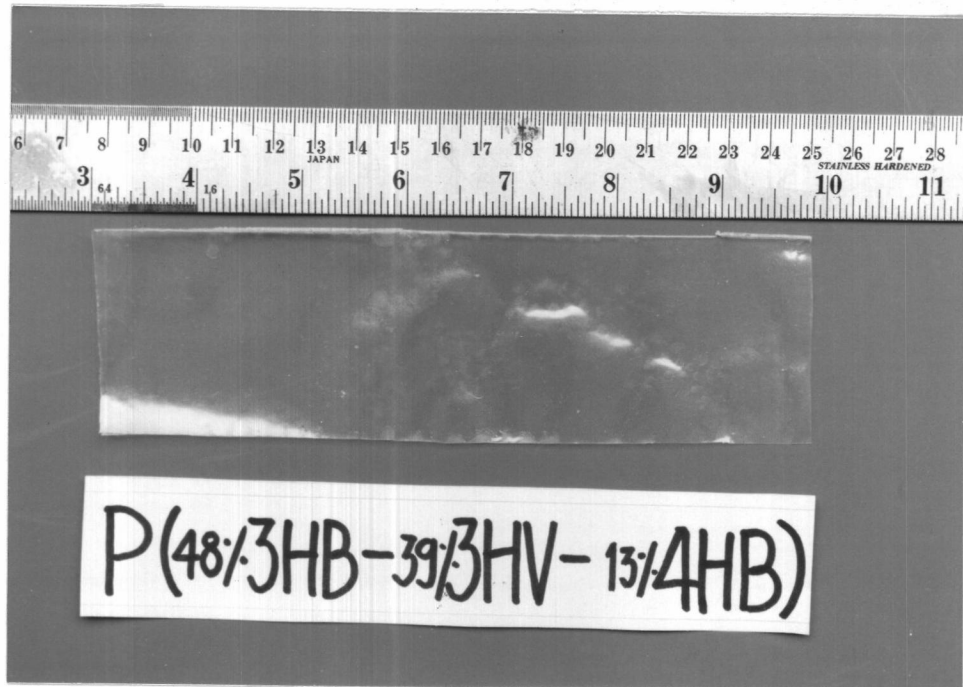
รูปที่ 33 แผ่นฟิล์มของสารผลิตภัณฑ์ P(48% 3HB-39% 3HV-13% 4HB) ซึ่งได้จากการเลี้ยง Alcaligenes sp. A-04 โดยผ่านการสกัดและทำให้บริสุทธิ์
