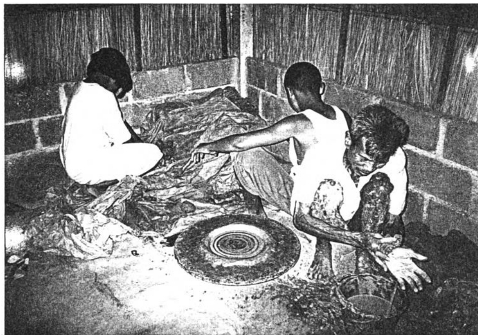
ภาพที่ 5 แสดงลักษณะของแป้นหมุน (พะมอน)
