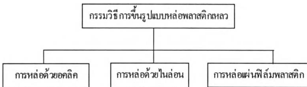
รูปที่ 2.7 แสดงกลุ่มของการขึ้นรูปแบบหล่อพลาสติกเหลว
