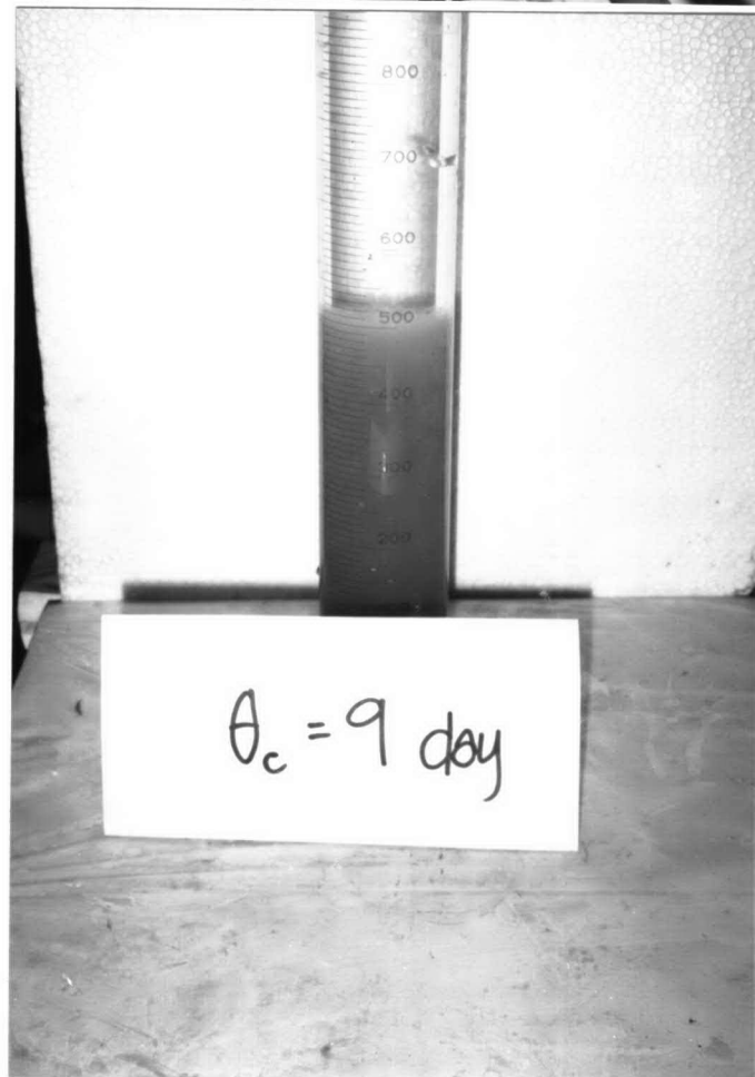
ภาพที่ 5.10 ภาพถ่ายการหาค่า V30 ในวันสุดท้ายของการทดลองย่อยที่ 1.3 ( อายุสลัดจ์ 9 วัน )
