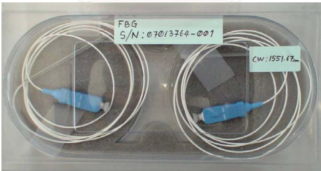
รูปที่ 37 Fiber Bragg Grating ที่ใช้ในการทดลอง
