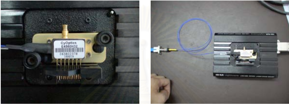
รูปที่ 5 EML และ Laser Mount ที่ใช้ในการทดลอง
